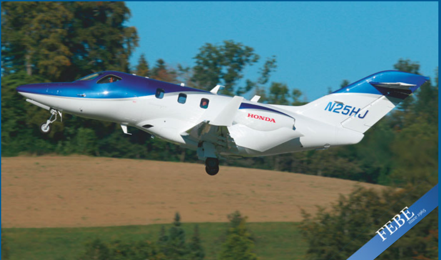
Der HA-420 HondaJet war eine Typenpremiere für Bern. Das Design besticht durch die Anordnung der Triebwerke über dem Flügel. Foto: L. Rösler, FEBE
