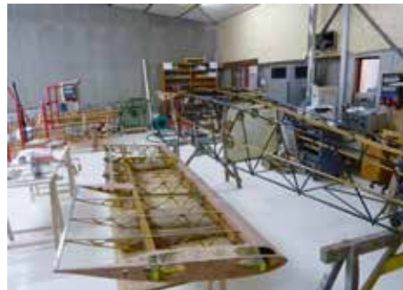
Komplettrevision einer Bücker 131 im Airmatec-Zweigbetrieb am Flughafen Thun.
